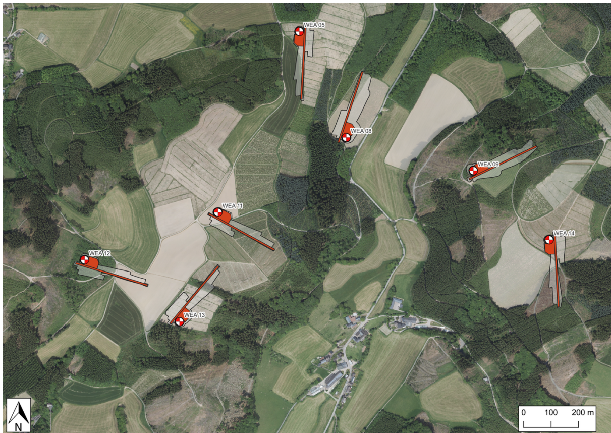
Abbildung 1 Darstellung der dauerhaften Eingriffsbereiche (Fundament, Kranstellflächen; rot), der temporären Eingriffsbereiche (Böschungsbereiche, Montageflächen, Kranausleger; weiß kariert) und der geplanten WEA (rot/weiß) im Untersuchungsgebiet Eslohe-Henne. Quelle: Digitale Orthophotos NRW (DOP) © Geobasis NRW (2025).
